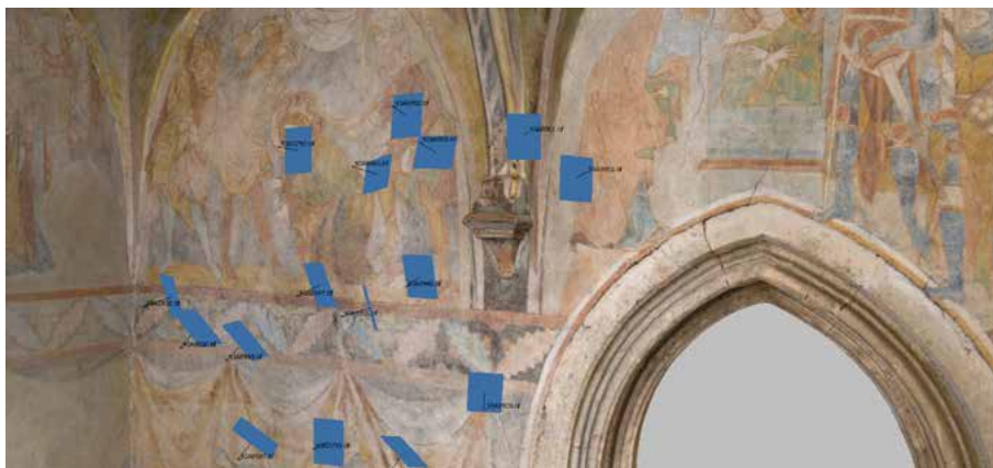
Abb. 26 Göttsweigerhof-Kapelle, Stein an der Donau. Ausschnitt der S-Wand des Vorraums mit der Darstellung der Kamerapositionen. Die blauen Flächen geben die Position und Orientierung der Aufnahmen wieder. Die Einzelbilder beziehen sich im ausgewählten Beispiel auf die Konsole. (Screenshots Agisoft PhotoScan) Fotos: Peter Böttcher 2016; Modell: Gábor Tarcsay, Michaela Zorko 2017.
