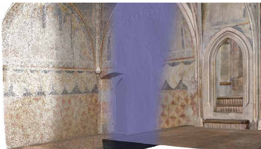
Abb. 27 Göttsweigerhof-Kapelle, Stein an der Donau. Überblick der W-Wand und N-Wand des Kapellenraums. Darstellung der einzelnen Rechenschritte im Zuge der Erstellung der 3D-Rekonstruktion. Visualisierung von links nach rechts: sparse point cloud, dense point cloud, mesh und texturiertes 3D-Modell. (Screenshots Agisoft PhotoScan). Fotos: Peter Böttcher 2016; Modell: Gábor Tarcsay, Michaela Zorko 2017
