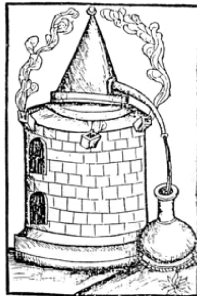
Abb. 8: Darstellung eines Rosenhutes sowie einer kompletten Destillationsapparatur bestehend aus Ofen, Rosenhut, Schale und Auffanggefäß bei Brunschwig (1512).
