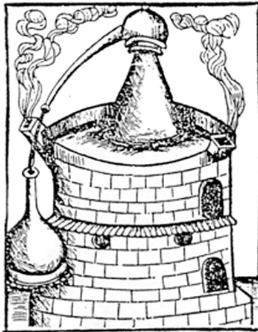
Abb. 9: Darstellung eines Alembiks als Teil einer kompletten Destillationsapparatur bei Brunschwig (1512). Aus Kurzmann, Destillation 49.
