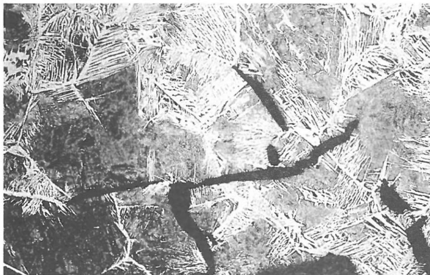
Abb. 8: Schlacke Fnr. 1278: 50-fache Vergrößerung, Ätzung mit Nital, Widmannstättengefüge mit nicht eingestreckten Schlacken
