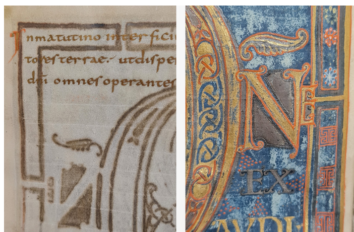
Abb. 10 Dagulf-Psalter, Detail von Folio 108v: Migration von Korrosionsprodukten des Silbers (links) und Detail von Folio 108r: Korrosion der Silbertusche (rechts).
