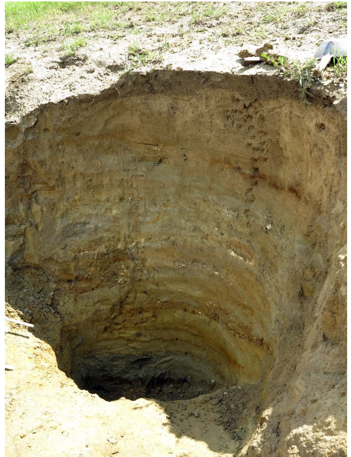
Abb. 3 Die Stratigrafie der Lehmgrubenwand auf der Lehmbaustelle im Museumsdorf Niedersulz/NÖ zeigt unterschiedliche geologische Schichten. Anhand der schichtenspezifischen Eigenschaften des Lehms können dessen Einflüsse auf die Eignung zur Verarbeitbarkeit für bestimmte Bautechniken nachvollzogen werden.
