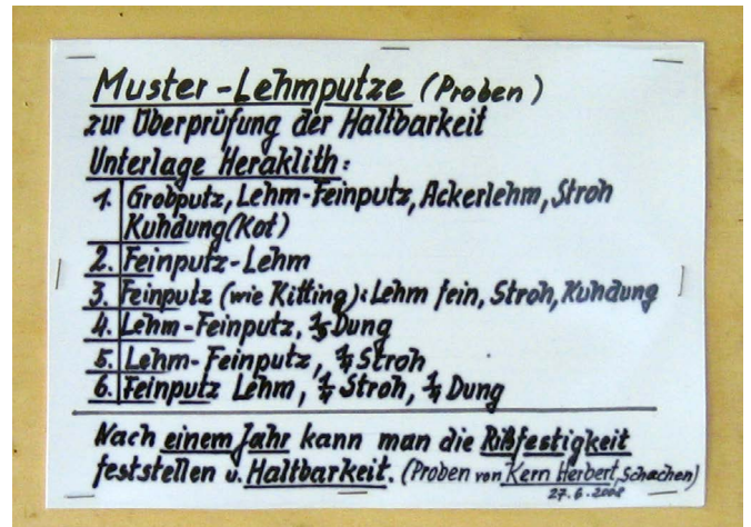
Abb. 12 Rezepte für Musterlehmputze, welche im Freilichtmuseum Vorau auf einer Wand des „Kitting“ ausgestellt und beschildert sind.
